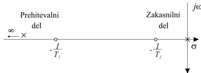
Slika 3.45: Poli in ničle PID regulatorjev
